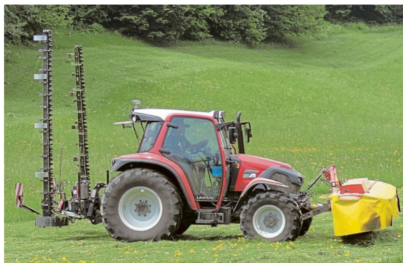
Bei dieser Kombination von Scheiben- und Doppelmessermähwerk verdreifacht das Heckmähwerk die Arbeitsbreite und dient gleichzeitig als „aktiver“ Ballast.
