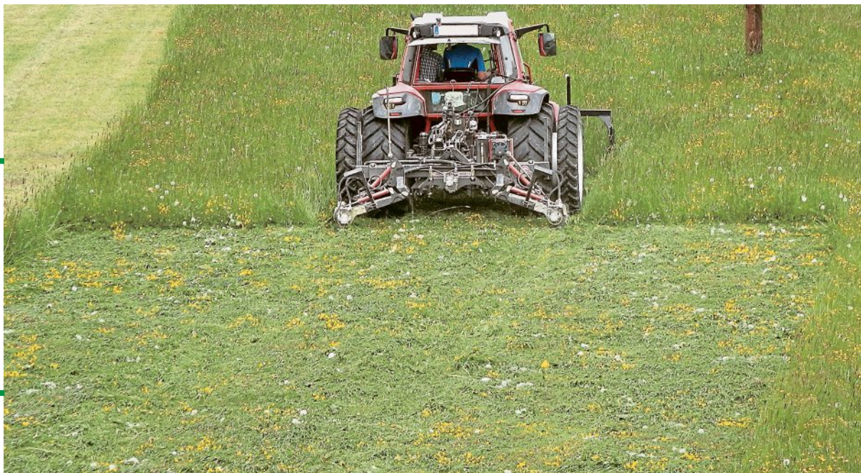
Doppelmessermähwerke ermöglichen große Arbeitsbreiten mit relativ geringem Gewicht und niedrigem Leistungsbedarf. Das Gras liegt direkt nach dem Schnitt sehr gleichmäßig und nutzt die gesamte Sonneneinstrahlung zum Trocknen.
