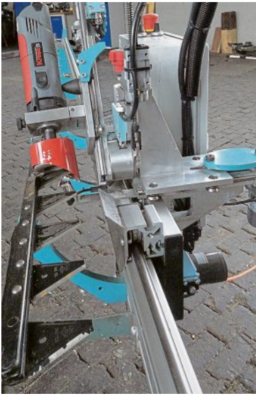
Um den Wartungsaufwand im Rahmen zu halten, bieten einige Hersteller auch Schleifautomaten an.
